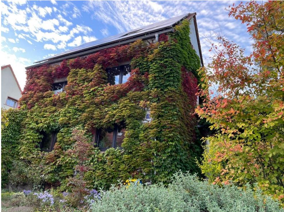
Abbildung 17: Fassadenbegrünung als Beitrag zu Hitzeschutz und Wasserhaushalt auf Gebäudeebene
